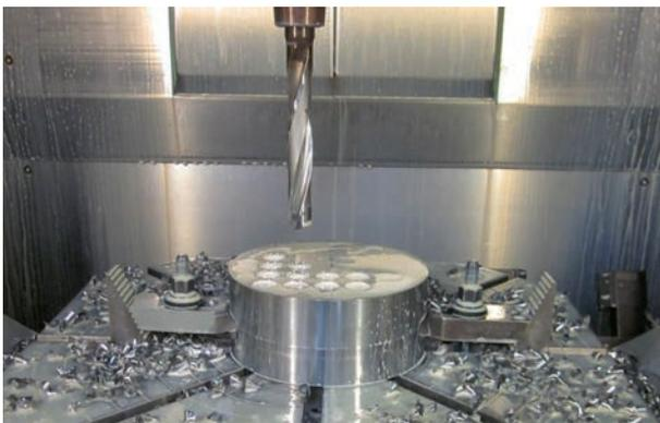
Bohrversuch mit modularem Werkzeug
