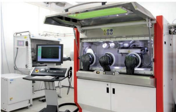
EOS EOSINT  $\mu$ 60, für Additive Mikrofertigung komplexer Bauteilgeometrien
