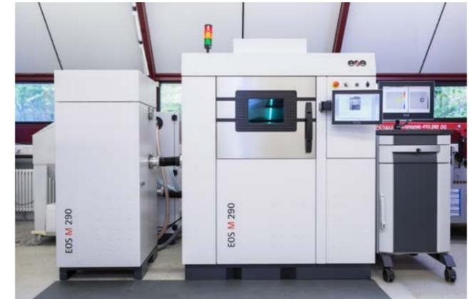
Additives Fertigungssystem für Metallbauteile EOS M290
