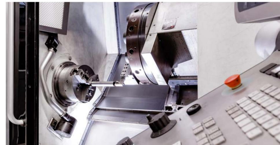
Drehbearbeitung mittels additiv gefertigter Werkzeughalter
