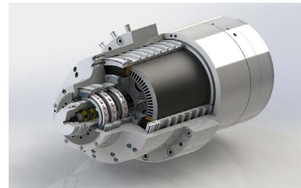
Prototyp der Motorspindel mit Synchronreluktanzmotor
