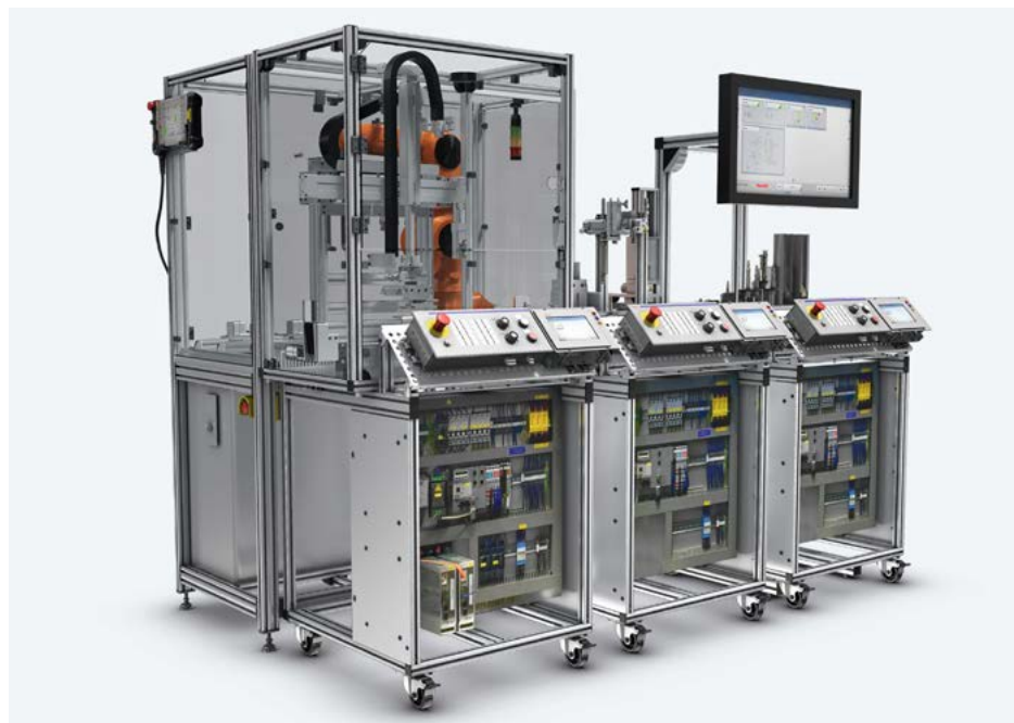
Modulares Industrie 4.0 Trainingssystem für das Versuchsfeld am PTW Quelle: Bosch Rexroth AG
