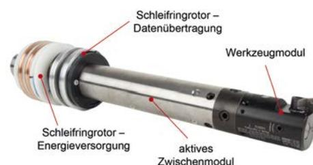
Zusammengebauter Prototyp des aktiv gedämpften Ausspindelwerkzeugs
