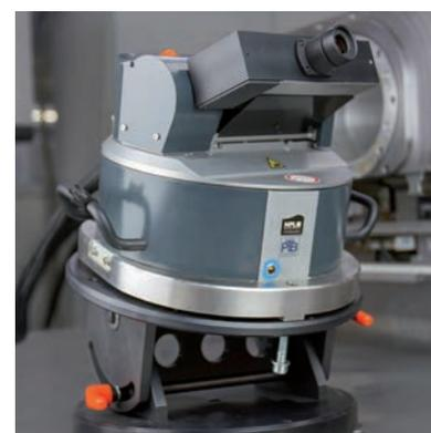
Maschinenvermessung mit dem Laser-Tracer-System
