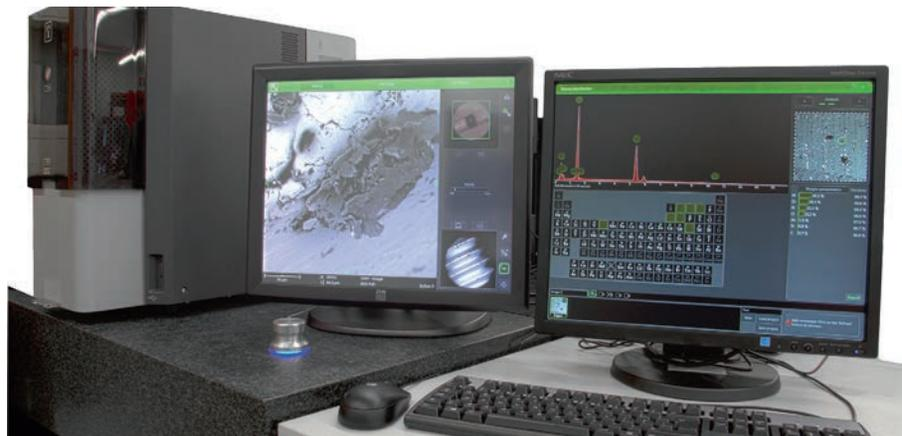
Desktop Rasterelektronenmikroskop Phenom Pro-X
