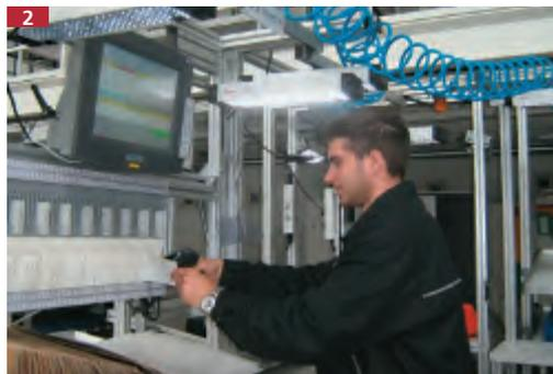
**Abbildung 2** • Lean Production meets Lean IT – Ein Werker meldet einen Arbeitsgang mittels Barcode am HYDRA-Terminal an.
