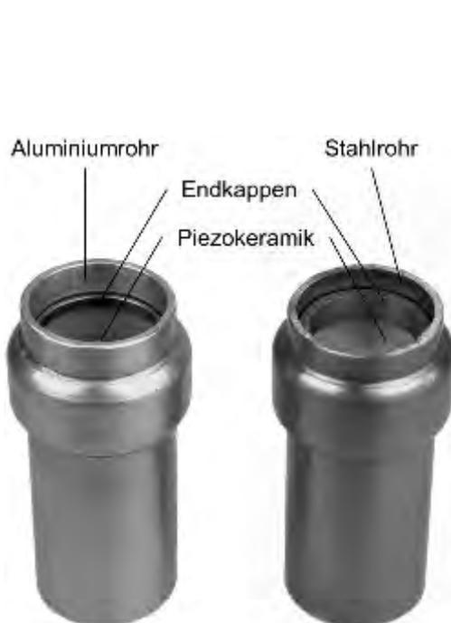
**Bild 1** • Integrierte Piezokeramik in umgeformtem Aluminium- (links) und Stahlrohr (rechts)
