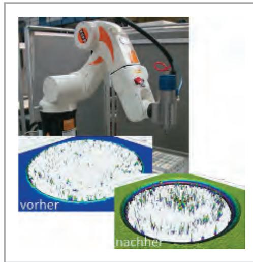
**Bild 1** • Verwendetes Robotersystem, Aufnahme einer unbearbeiteten Bohrungsverschneidung sowie einer entgrateten Bohrung
