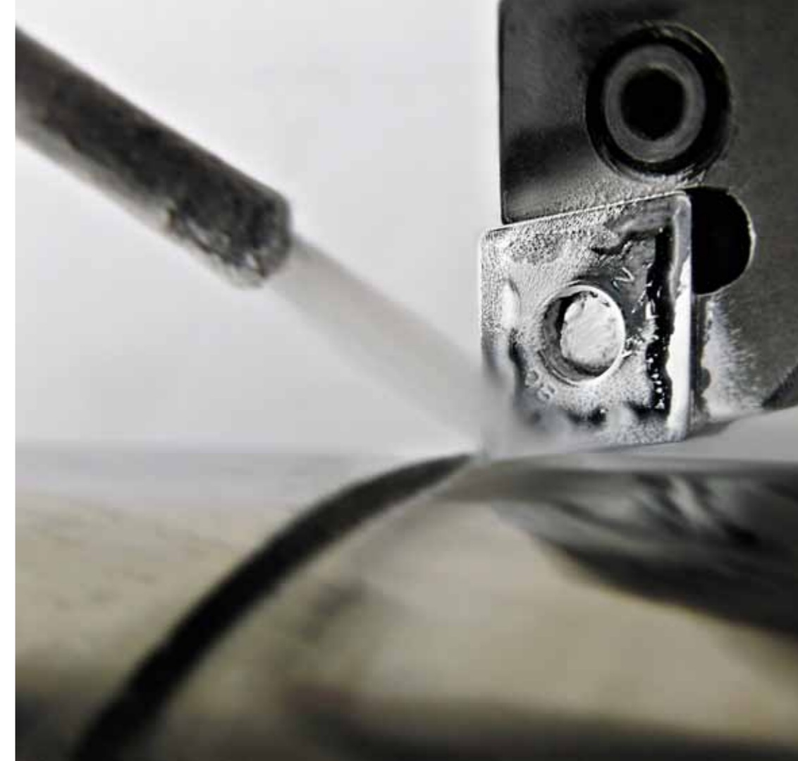
Innovativer Ansatz: CO 2 -Schneekühlung in der Guss- und Titanbearbeitung
