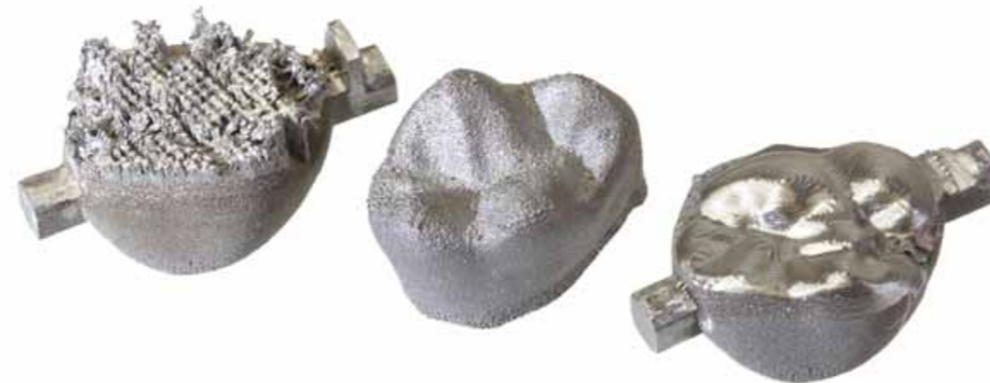
Hybride Prozesskette: Fertigung von Zahnkronen durch Verknüpfung additiver Prozesse (links) mit abtragenden Fertigungsverfahren (rechts)
