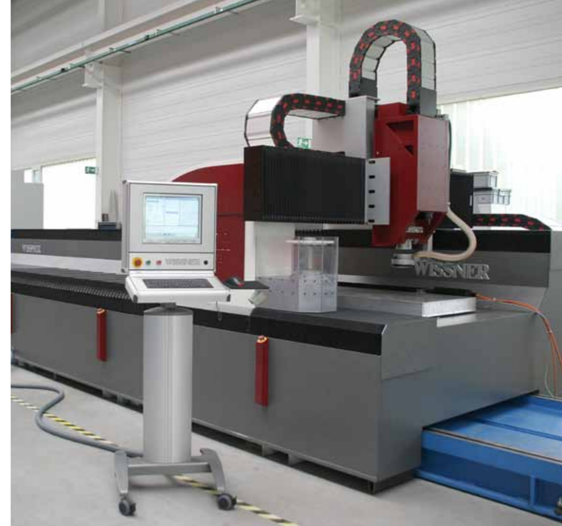
Modul zur fräsenden Blechbearbeitung
