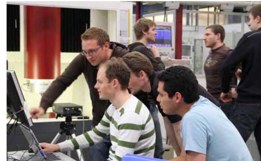
Untersuchung der Positioniergenauigkeit einer Werkzeugmaschine mit Hilfe eines Laserinterferometers
