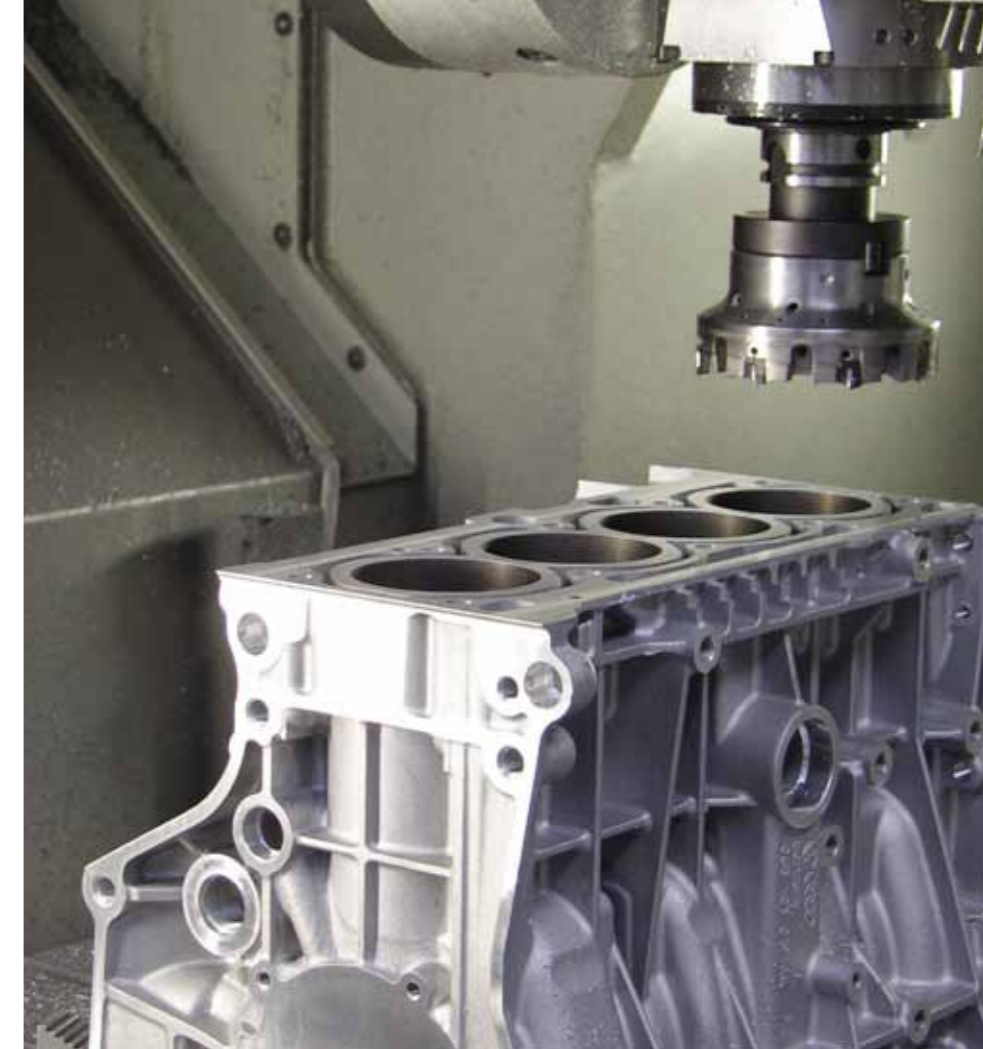
Schlichtbearbeitung am Motorblock
